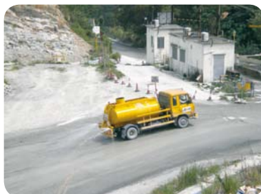
水車於路面灑水
